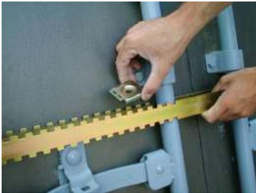
1.) Platzieren Sie die NEW FORKSEAL zwischen den Mittelstangen des Behälters und setzen Sie die erste Verbindung so nah wie möglich an der Stange ein.
