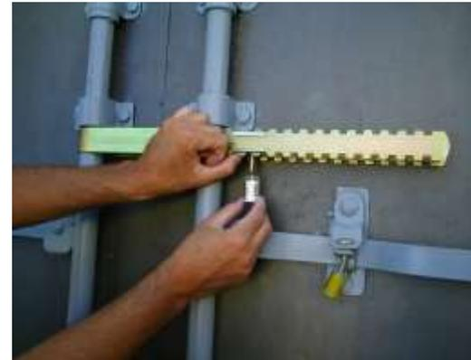
4.) Setzen Sie die endgültige Verschlusskapsel ein und klicken Sie auf den Verriegelungsmechanismus. Von diesem Moment an besteht keine Manipulationsmöglichkeit mehr.
