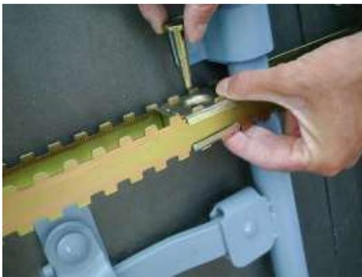
3.) ...Setzen Sie die Barrierenplombe ein, der DIE ABMESSUNGEN HAT, um Manipulationsversuchen vorzubeugen
