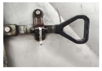
Auf diese Weise wird die Verriegelung der Plombe erreicht. Die einzige Möglichkeit, es zu öffnen, besteht darin, es zu zerbrechen.
