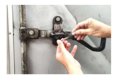
Setzen Sie das Ende der Plombe im hinteren Loch des Plombenskopfes ein.
